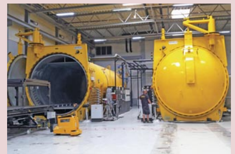
Bei Cotesa im Mochauer Gewerbegebiet „Am Fuchslotch“ werden aus Gewebe aus Glasfasern Flugzeugteile gefertigt: Zunächst wird dafür das hauchdünne, mit Harz verstärkte Material an einem Cutter entsprechend zugeschnitten (v. l. o.), anschließend werden die einzelnen Bestandteile in Form gebracht. In den Autoklaven (oben rechts) wird das Gewebe unter Druck verpresst und ausgehärtet. Bis zu 400 Grad Celsius können in diesen Druckkesseln erzeugt werden. Fotos(6): Maria Fricke
