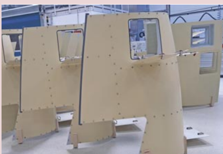
Die fertig geformten Teile werden mit einer entsprechenden Grundierung versehen und vor Ort zu einer komplexen Einheit zusammengesetzt, welche direkt zum Flugzeughersteller ausgeliefert wird. Zur Produktpalette gehören auch ein spezieller Transportcontainer (u. rechts) sowie Wassertanks für Trink- und Abwasser aus Carbon.
