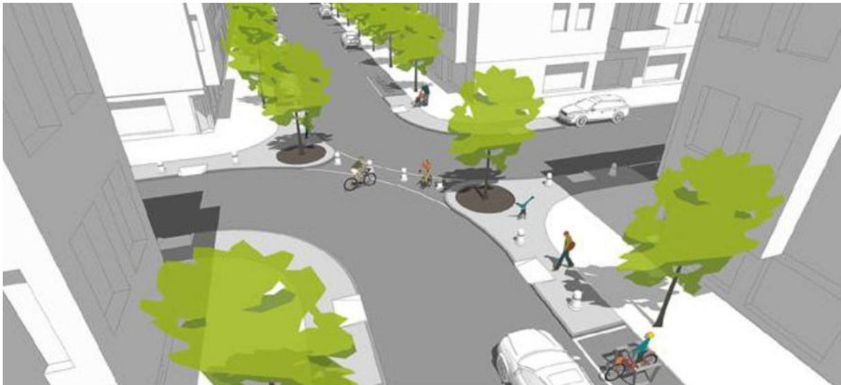
Abbildung 59: Schemadarstellung einer Diagonalsperre. Quelle: ADFC
