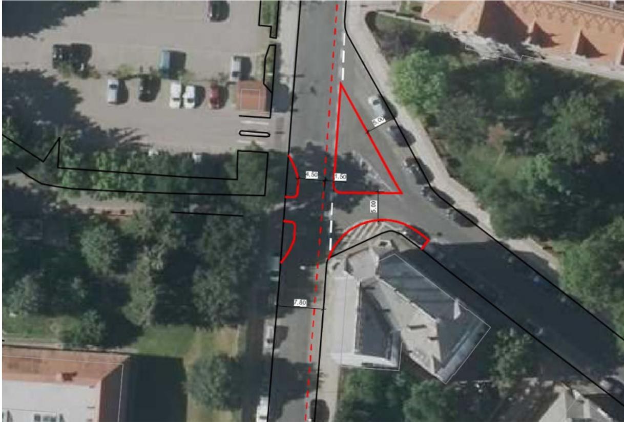
Abbildung 63: Mittels Markierung können die verfügbaren Flächen gerechter aufgeteilt werden
