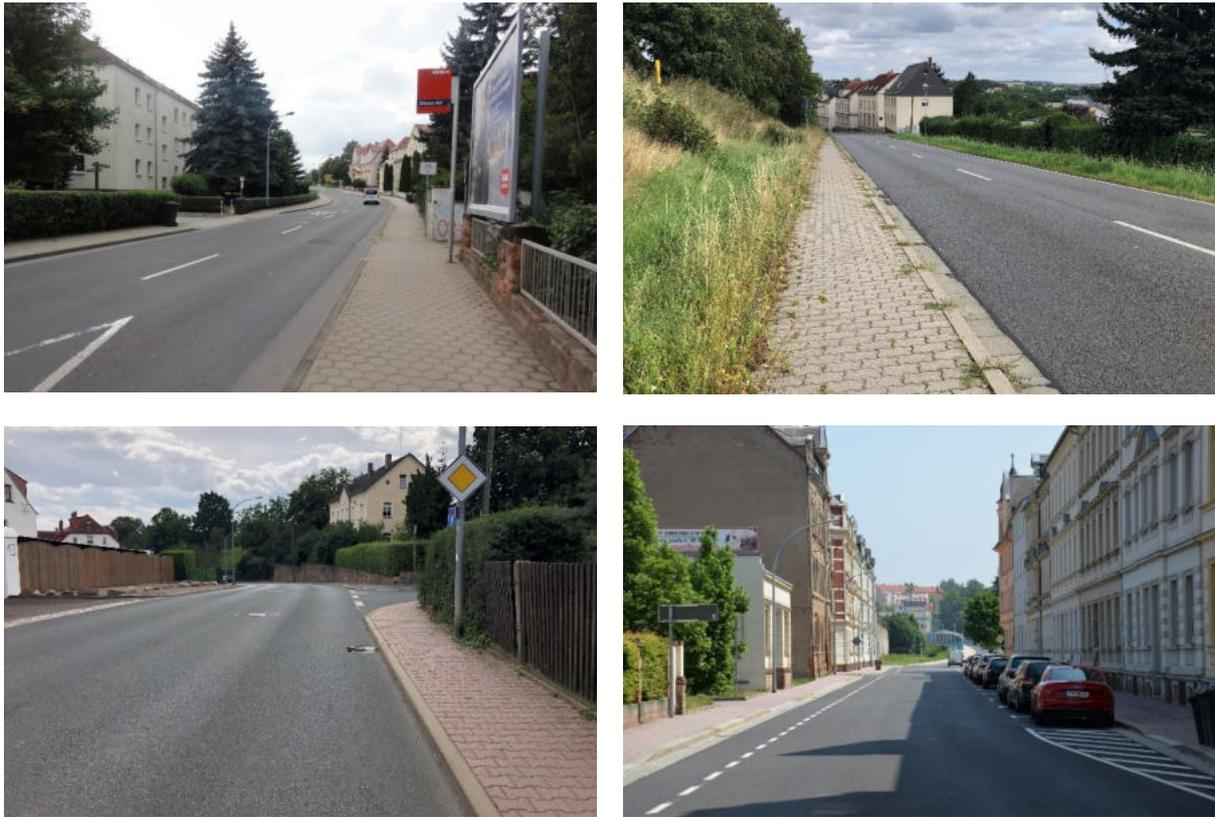
Abbildung 19: Hauptverkehrsstraßen mit fehlenden Radverkehrsanlagen
